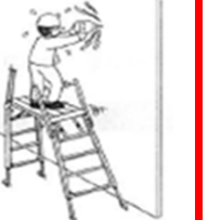
反動のかかる作業は、横連結(専用部材)で作業する
