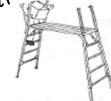
上向き作業は、補助手摺を両側に設置。または、安全帯を使用する。
