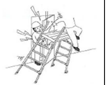
上向き作業は、補助手摺を両側に設置。または、安全帯を使用する。
