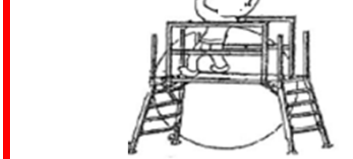
上向き作業は、補助手摺を両側に設置。または、安全帯を使用する。
